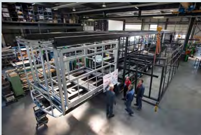
3 Aufbau des Gitterrohrrahmens.
